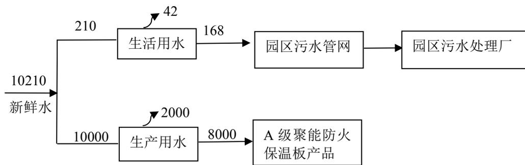
图 1 项目给排水平衡图 单位:  $\text{m}^3/\text{a}$
