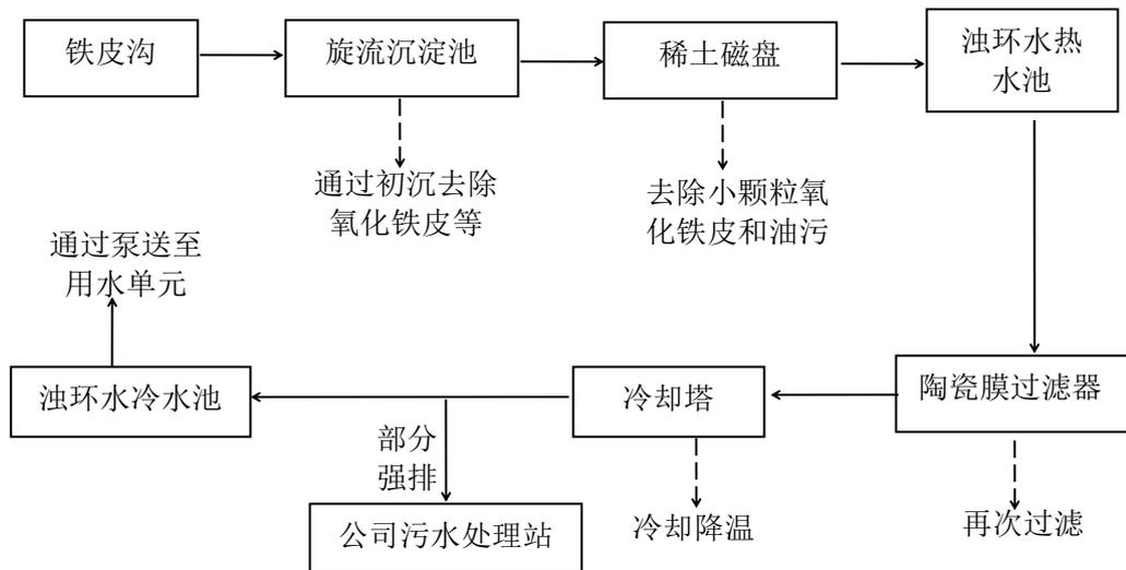
图 4-1 本项目连铸浊水处理工艺流程图
