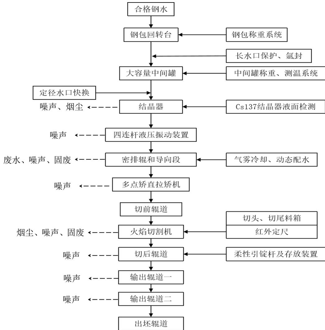
图 2-8 连铸生产工艺流程及产污环节图
