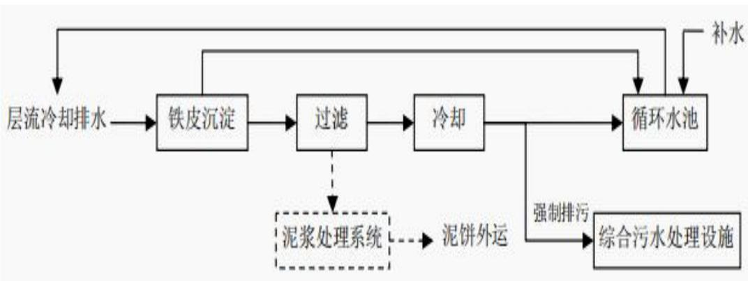
图 4-6 热轧层流冷却水处理工艺流程图 (图 13)
