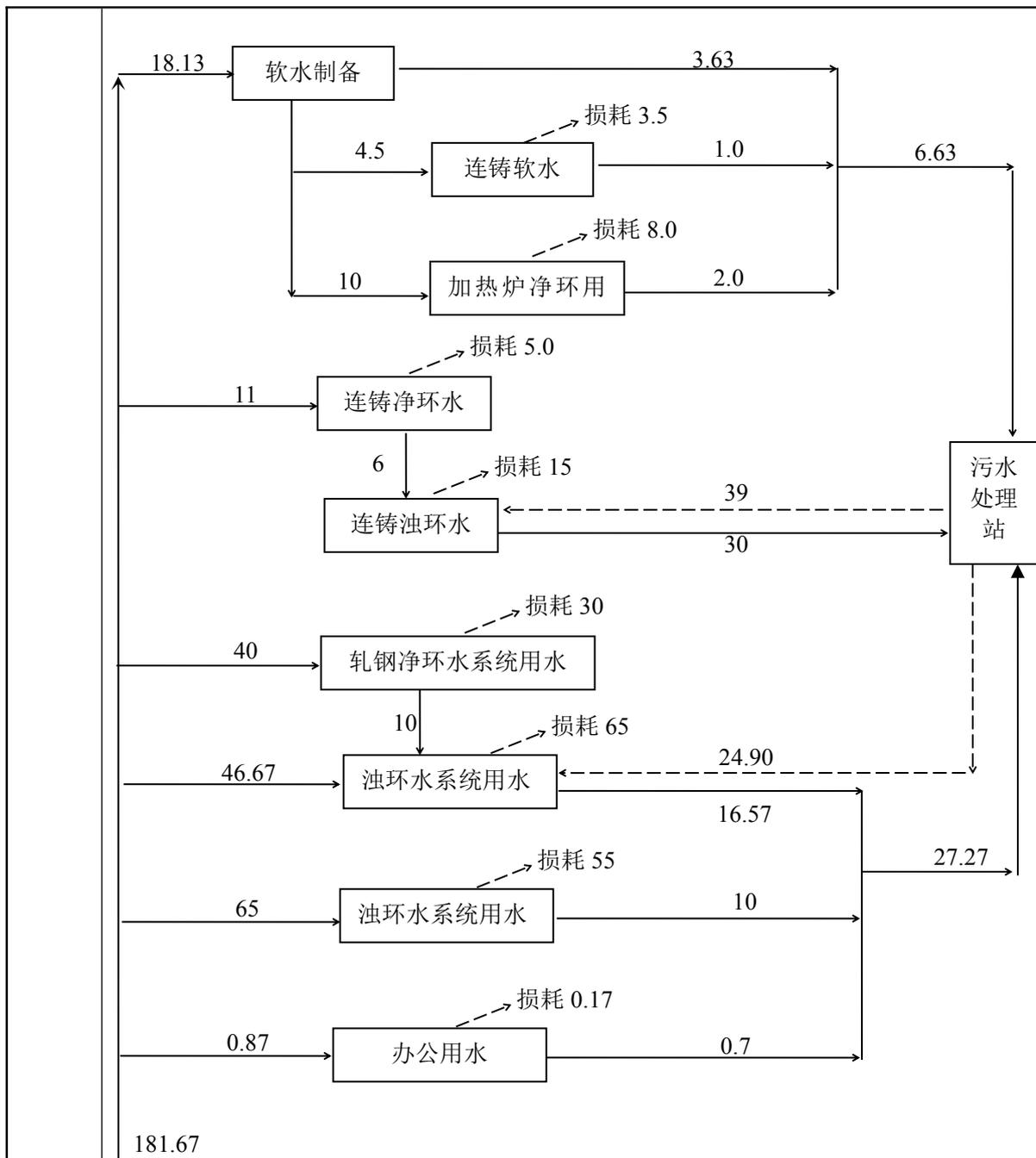
图 2-4 本项目水平衡图 (单位: m³/h)
