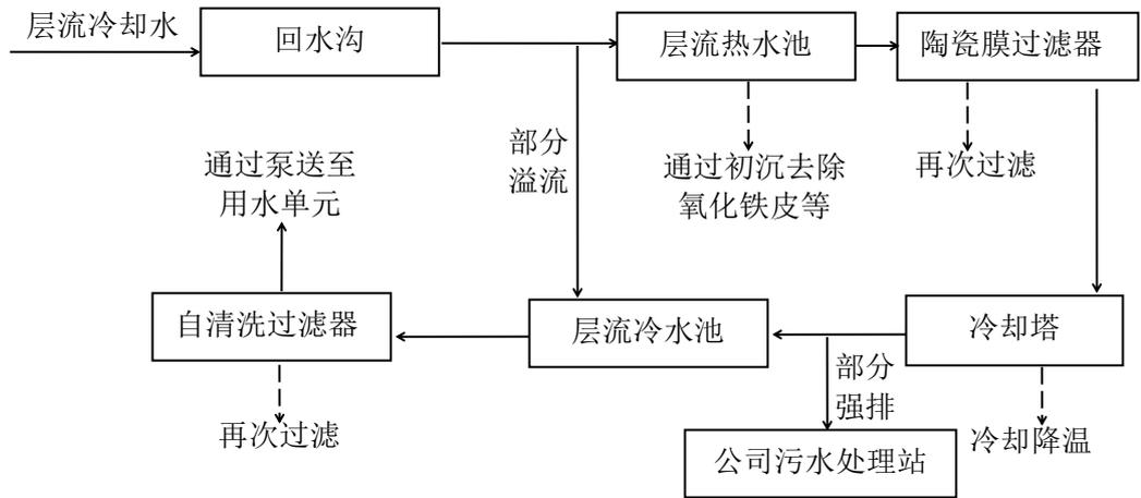
图 4-3 本项目热轧层流水处理工艺流程图
