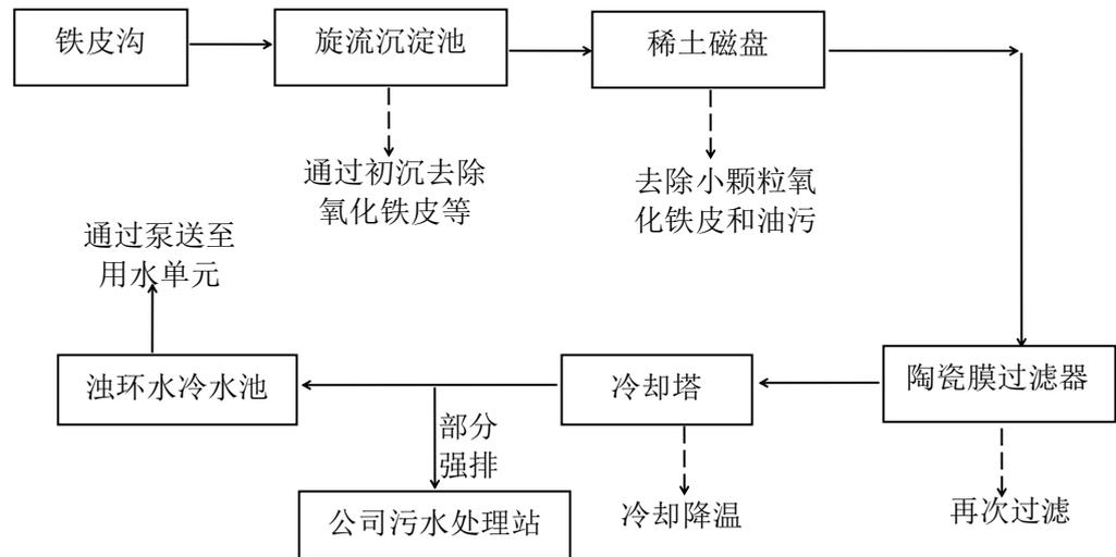
图 4-2 本项目热轧浊水处理工艺流程图
