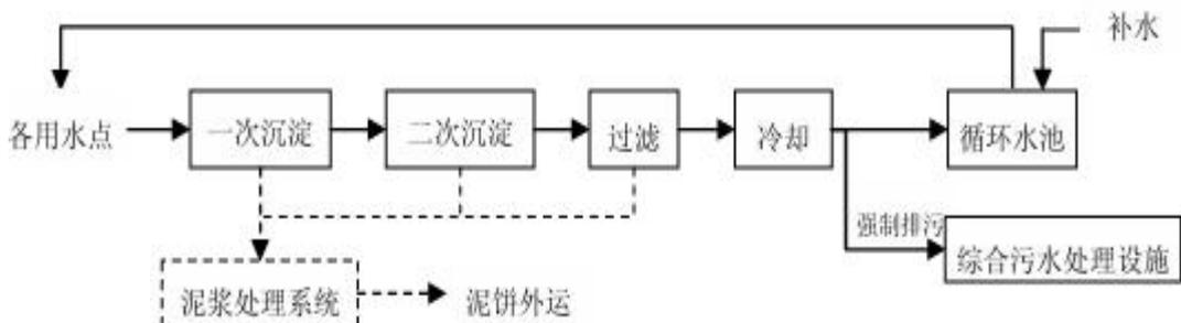
图 4-4 连铸生产废水处理工艺流程图 (图 11)
