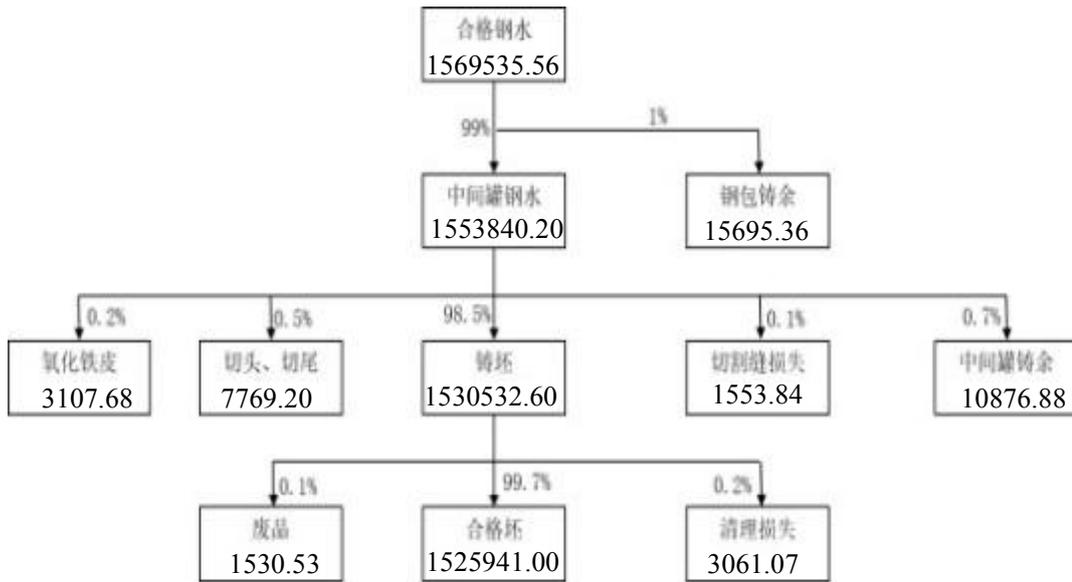
图 2-5 连铸工序金属平衡图 (单位: 吨/年)
