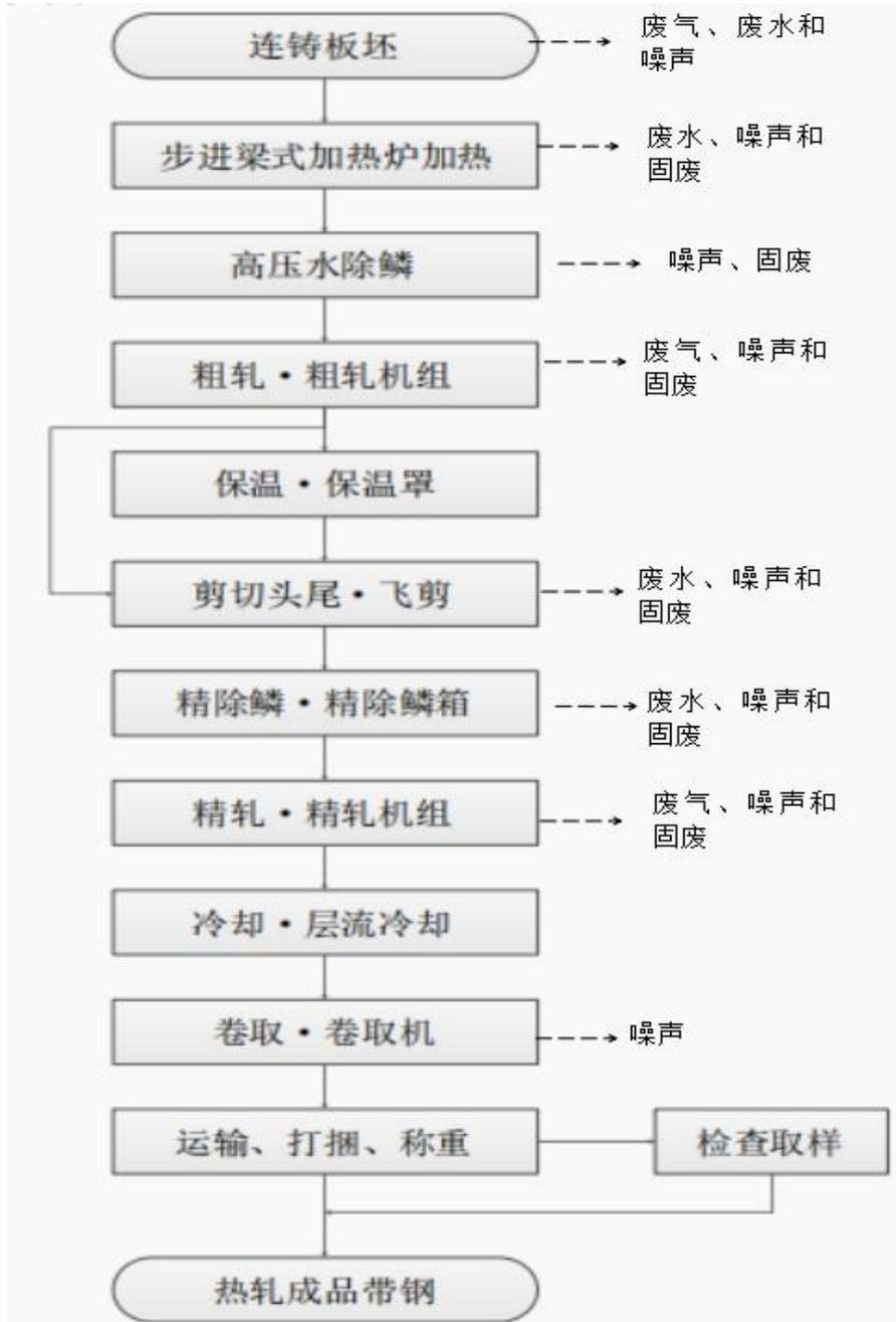
图 2-9 850mm 热连轧机组生产工艺流程图
