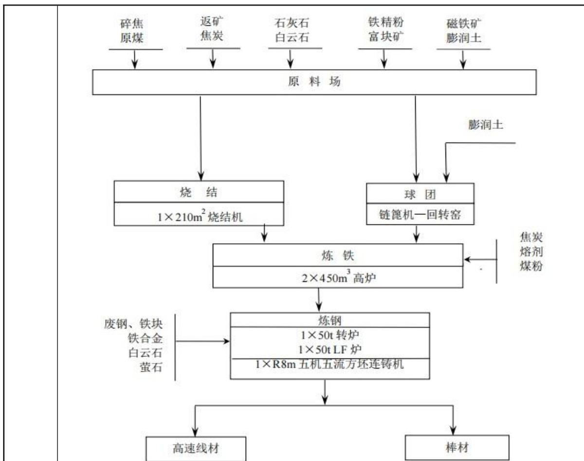
图 2-13 昆玉钢铁总体生产工艺流程图
