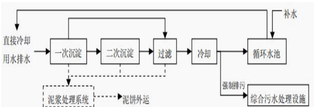
图 4-5 热轧直接冷却水处理工艺流程图 (图 12)
