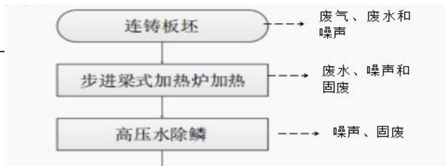
图 2-9 850mm 热连轧机组生产工艺流程图
